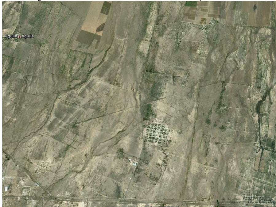
Figura 99. Obsérvense los escurrimientos cortados por la carretera
