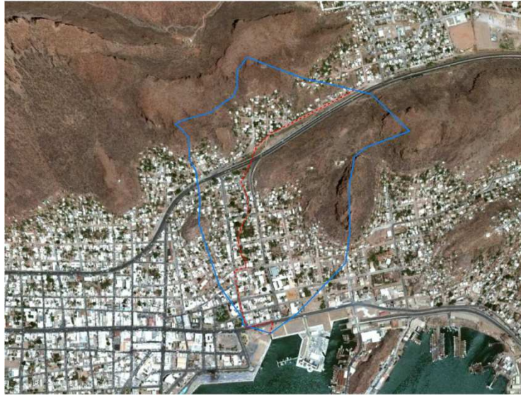
Figura 112. Cuenca y cauce del arroyo de la calle 25
